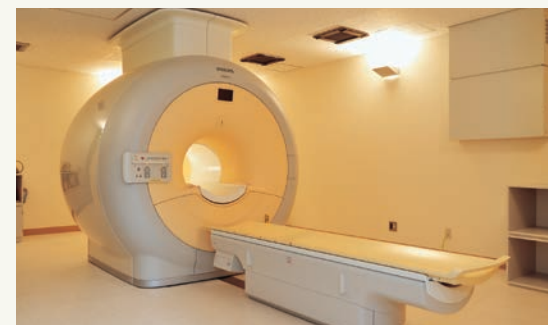
心臓用32チャンネルコイルを搭載した最新型MRI
